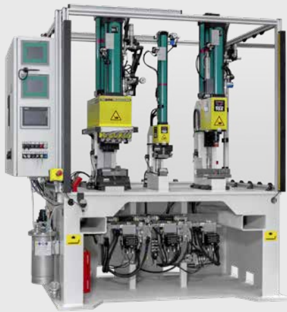
TOX®-Presse zum eClinchen von Sicherungskomponenten.
